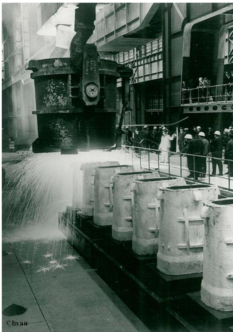
FOTO 11 – STANDUL DE TURNARE OLD 1 – PRIMA ȘARJĂ DE OȚEL SE TOARNĂ ÎN LINGOTIERE
